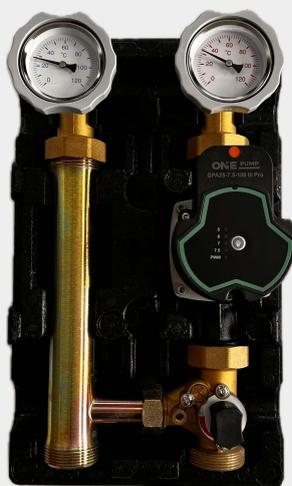
Il gruppo preassemblato di rilancio ad alta temperatura con valvola a tre vie e by pass è progettato per distribuire il fluido di mandata dell'impianto termico mantenendo la stessa temperatura del circuito primario della caldaia, pompa di calore o teleriscaldamento. Se necessario in relazione al collettore a disposizione o ad altre necessità impiantistiche, è possibile prevedere la mandata a DX: invertire le tubazioni di mandata e ritorno.
