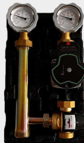
Il gruppo preassemblato di rilancio con miscelazione a punto fisso è progettato per distribuire il fluido di mandata dell'impianto termico a una temperatura regolata tramite il miscelatore termostatico, che consente una regolazione accurata della temperatura dell'acqua tra 35°C e 60°C. Ideale per termosifoni e fancoil. Se necessario in relazione al collettore a disposizione o ad altre necessità impiantistiche, è possibile prevedere la mandata a DX: invertire le tubazioni di mandata e ritorno.
